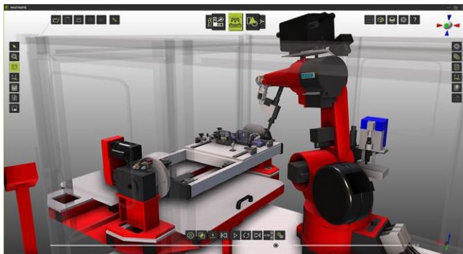
Lichtbogenschweißroboter mit FASTSUITE
