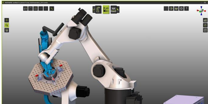
Simulation des 3D-Laserschweißprozesses mit dem TRUMPF TruLaser Robot 5020
