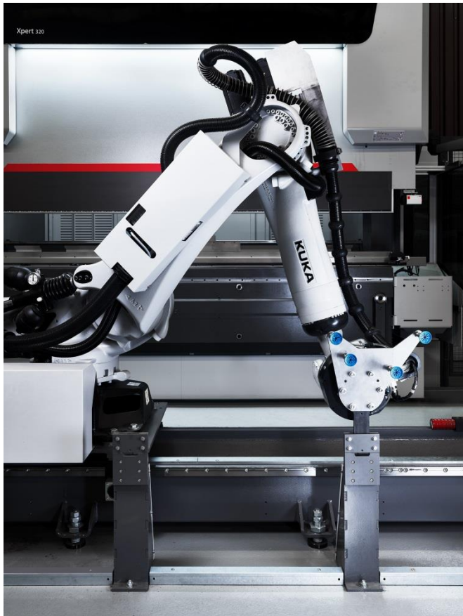
Wendig und autonom: Der 7-achsige Roboter eignet sich für Traglasten bis zu 270 Kilogramm und kann selbstständig Greifer und Biegewerkzeuge wechseln.
