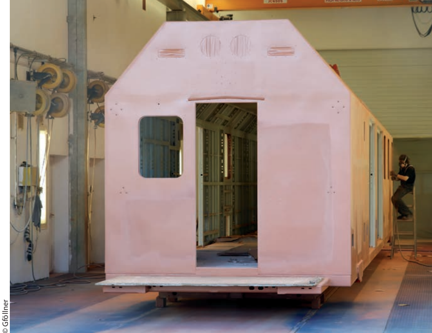
In der Lackierkabine können Schutzbeschichtungen bis zur höchsten Korrosivitätskategorie C5-M realisiert werden.
