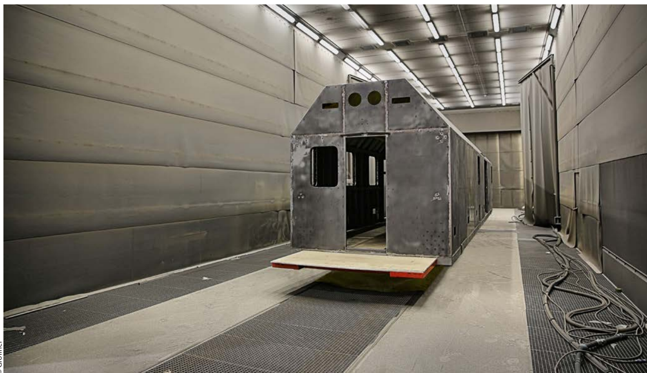
Bis zu 28 Meter lange Teile, beispielsweise Bahnwaggons, lassen sich in der großen Freistrahlanlage strahlen.
